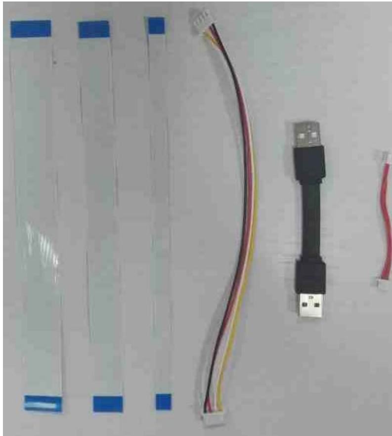
↑ FPC-40pin 排线 ↑ FPC-30pin 排线 ↑ FPC-15pin 排线 ↑ XH2.54 端子线 ↑ 公对公USB线 ↑ SH1.0 端子线
